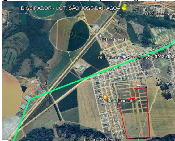
Figura 08: Ponto de dissipação das águas pluviais.
